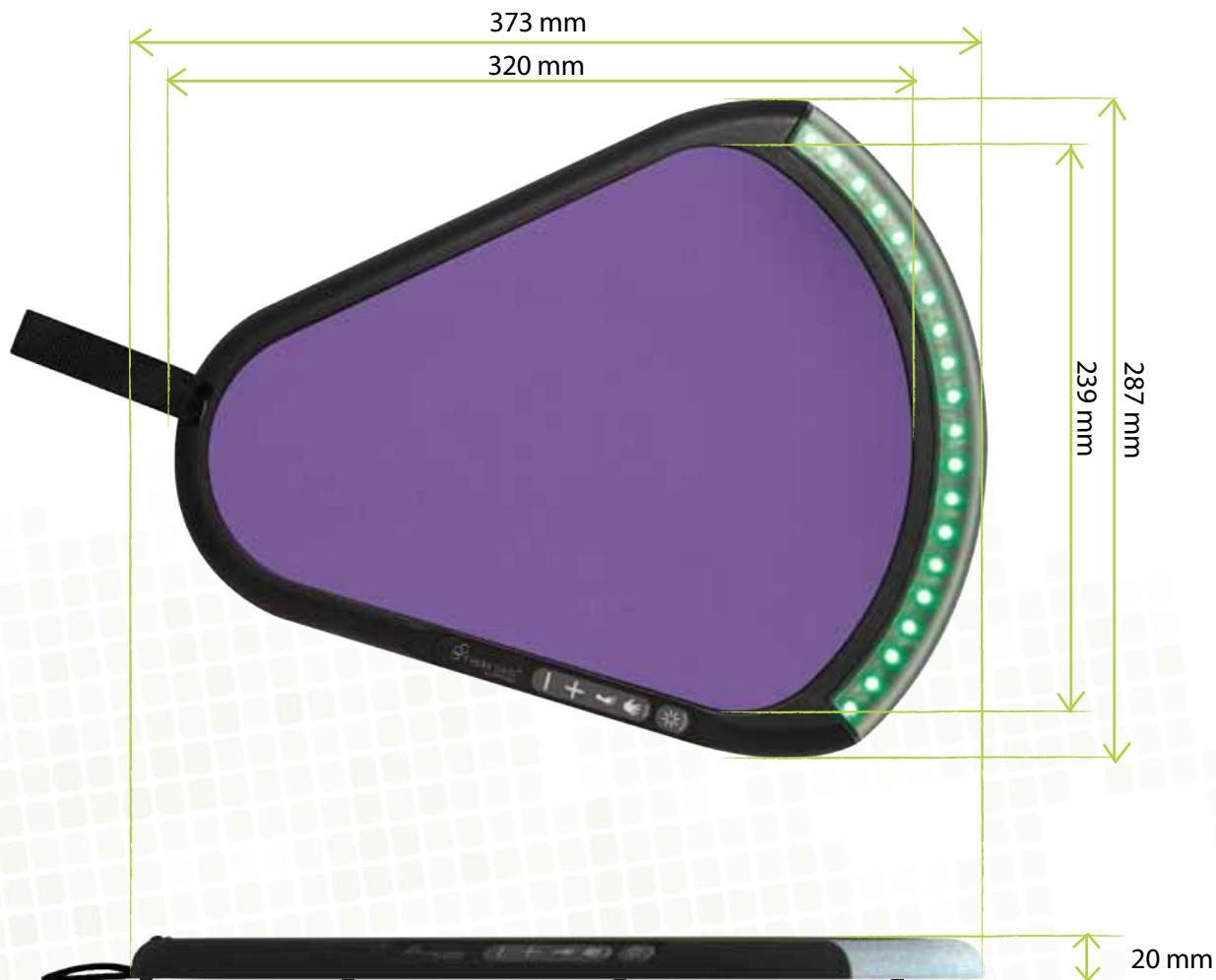
La taille et la forme des TREAX sont conçues pour accueillir la main ou le pied de l'utilisateur. La surface en caoutchouc correspond à la zone d'interaction. Chaque plot peut recevoir une taille de pointure 48,5. L'échelle de force est prévue pour des poids supportés allant de 15 à 150 kg.
