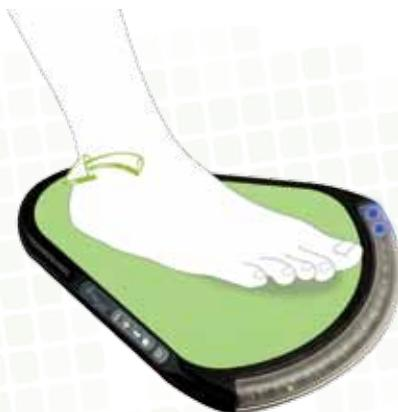
Si le poids exercé sur le talon augmente par rapport à l'avant du pied, les diodes bleues s'activent davantage vers la gauche.
