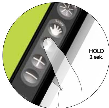
Le mode équilibre s'active en appuyant sur l'icône « pied » pendant environ 2 secondes. Quand le mode équilibre est choisi, TREAX indique la répartition du niveau de charge entre le talon et l'avant du pied.
