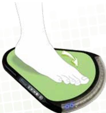
Si le poids exercé sur l'avant du pied augmente par rapport au talon, les diodes bleues s'activent davantage vers la droite.
